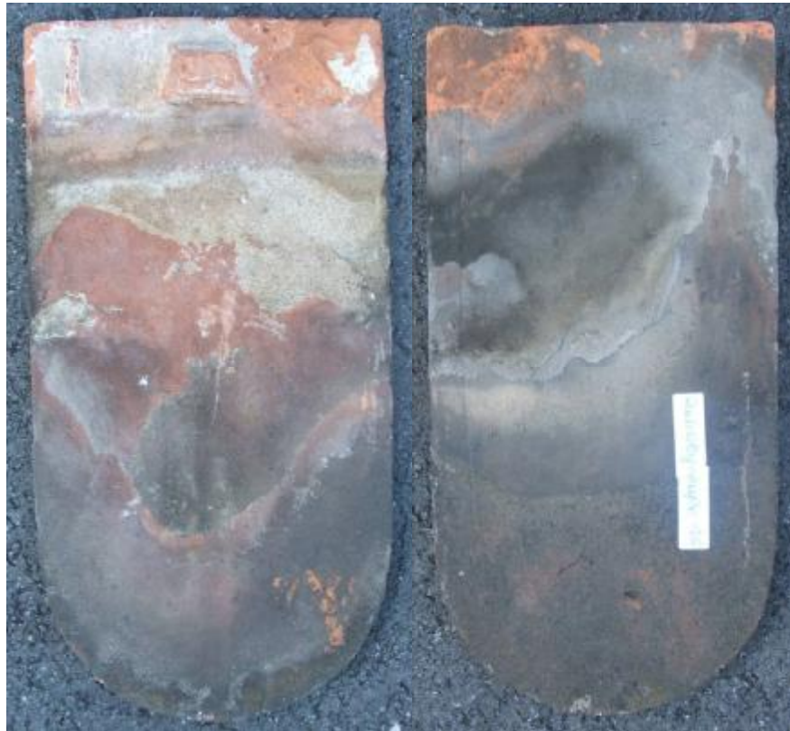
Abbildung 68: Biberschwanzziegel, Radetzkystraße 18, Format 42 x 21 x 1,8 cm, Initialen I S, ca. 1820 142
