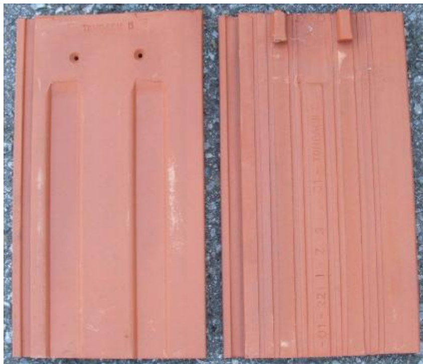
Abbildung 111: Strangfalzziegel aus der Gegenwart, System Steinbrück
