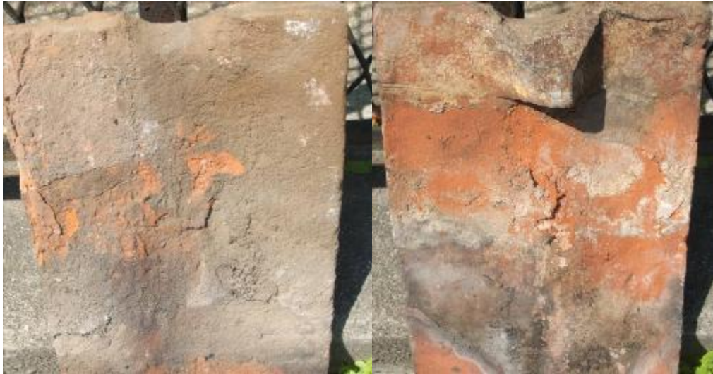
Abbildung 84: Handschlagziegel; Einkerbung durch Nachdrücken des Lehmtes bei der Nase
