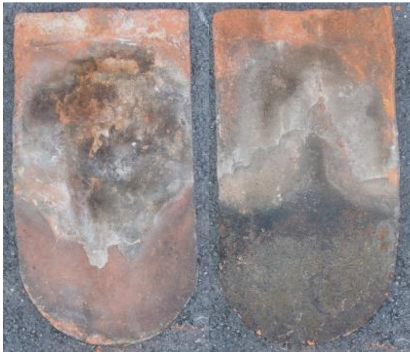
Abbildung 69: Biberschwanzziegel, Sporgasse 16, Format 44 x 23,5 x 2 cm, ca. 1840 144
