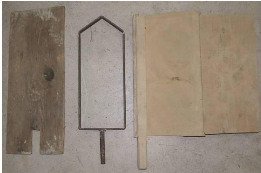
Abbildung 88: Unterlagsbrett mit Leinentuch, Streichrahmen und Trockenbrettchen v. rechts nach links; Stiftung Ziegelei-Museum Cham, Schweiz
