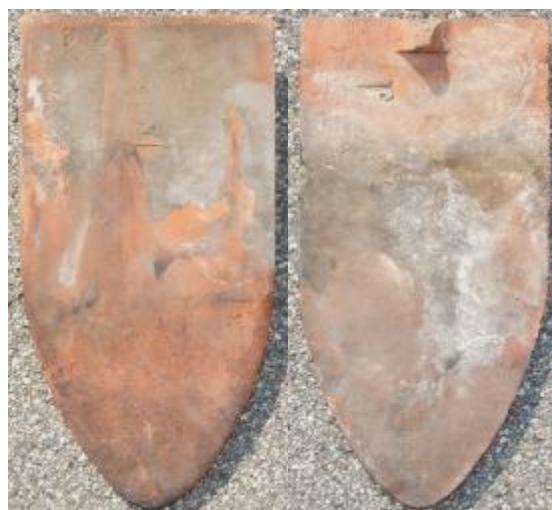
Abbildung 36: Durch Stempel gekennzeichnete Spitzbogenziegel von der Grazer Burg
