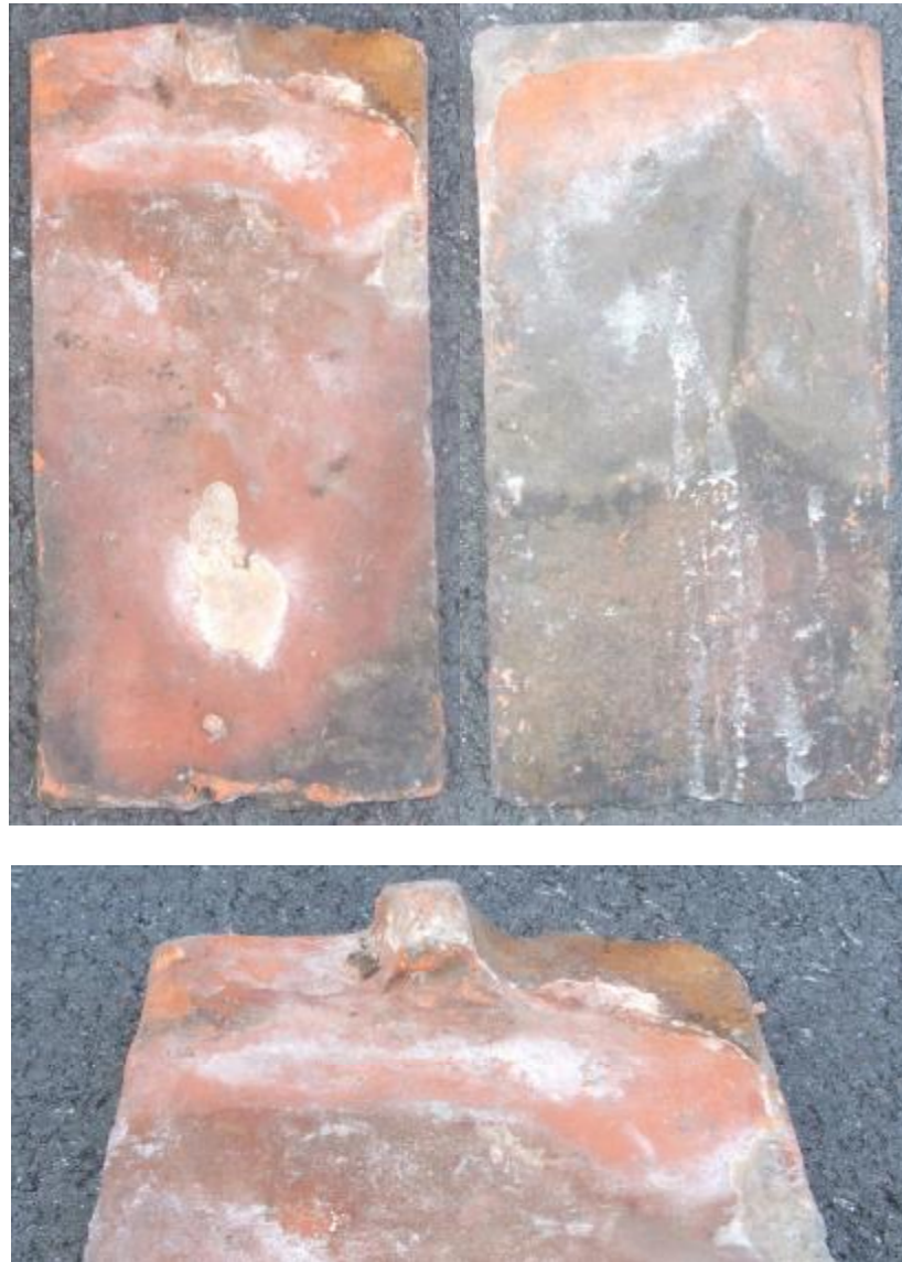
Abbildung 77: Taschenziegel Sporgasse 16, Format 40 x 20,5 x 2 cm, um 1565 151
