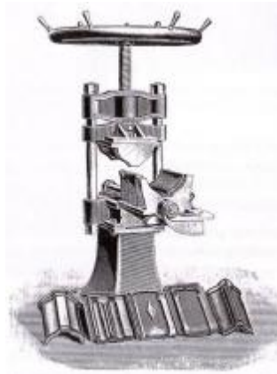
Abbildung 93: Schlittenpresse (Bender, Schrader 1999: 120)
