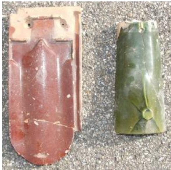
Abbildung 105: Turmfalzziegel Z3, Ludowici, Franckstraße 31, ausgebaute, beschädigte Ziegel
