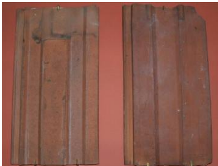
Abbildung 106: Strangfalzziegel System Stadler, Ziegmuseum Wien-Penzing
