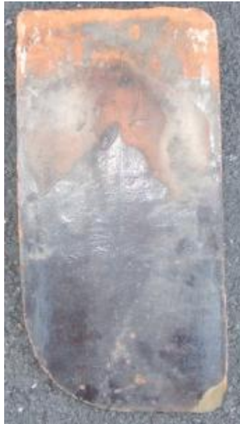
Abbildung 50: Halbseitig gerundeter, glasierter Ziegel ca. 44 x 21 x 1,5 cm, vermutlich Hödl, datiert 1834, vom Schauspielhaus
