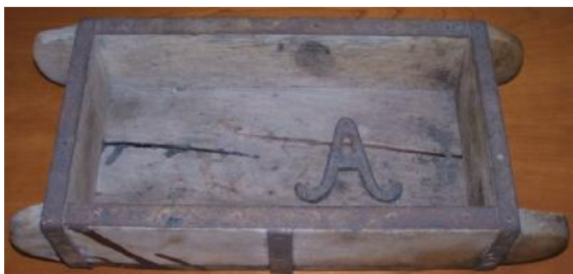
Abbildung 85: Mauerziegelmodel, Sammlung Ziegelwerke Gleinstätten
