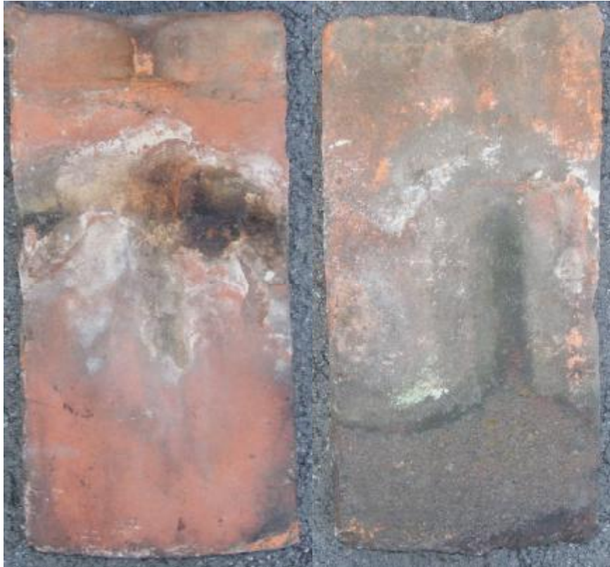
Abbildung 79: Taschenziegel, Färbergasse 1; Format 38,5 x 19,5 x 2 cm, um 1425 153
