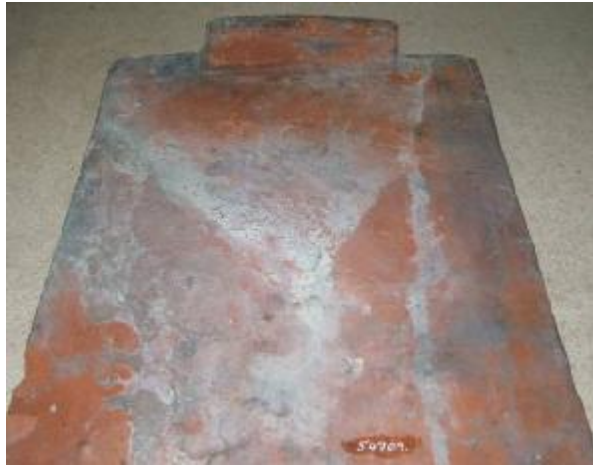
Abbildung 19: Dachziegel mit Aufhängeleiste vom Allerheiligenkloster Schaffhausen, 1. H. 12. Jhdt., Stiftung Ziegelei-Museum Cham, Schweiz
