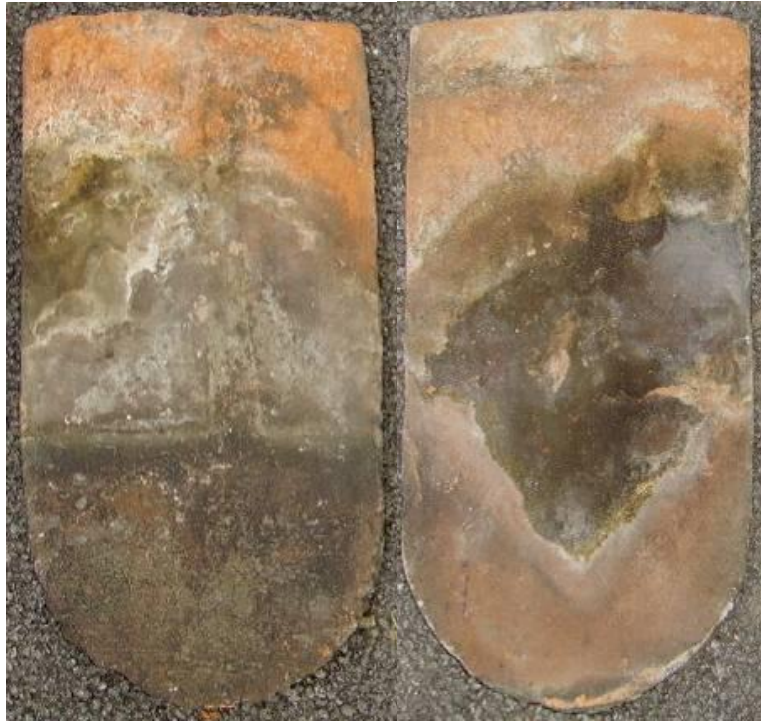
Abbildung 69: Biberschwanzziegel, Sporgasse 16, Format 43,5 x 22 x 1,6 -1,8 cm, ca. 1885 143
